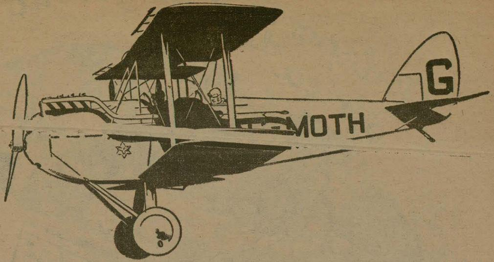
El aparato «Moth» de la casa «Havilland», prototipo de avionetas de turismo, ampliamente seguras. Frente a sus alas superiores se ve el dispositivo estabilizador Handley Page que evita los peligros de la pérdida de velocidad.
