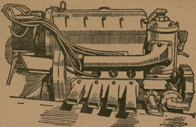
El nuevo motor Cozette, cuatro cilindros dobles, dos tiempos. A la derecha se distingue el sobrealimentador y en la parte baja los tubos de escape «decalados», respecto a la línea media, señalada por las bujías.
