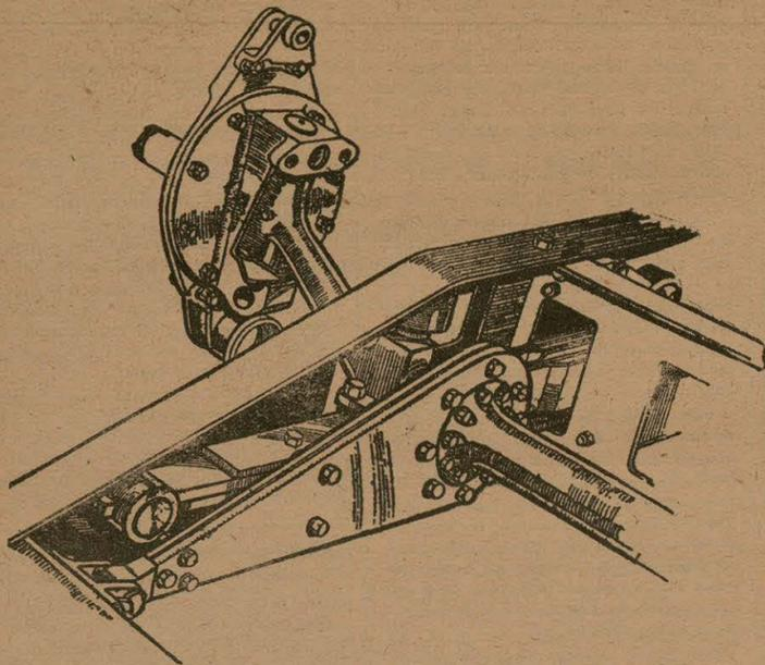
Detalle del eje y suspensión de antena
