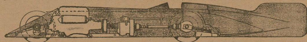
La silueta del super bólido que justifica su nombre de «Flecha dorada». Motor Napier 950 H. P. con 12 cilindros en tres bloques, cambio de directivas corrientes, dos ejes propulsores, uno para cada rueda y carrocería blindada, todo dispuesto para ser lanzado como un proyectil contra el record del mundo
