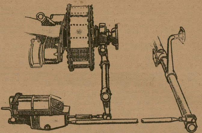
Una novedad del bólido de Segrave. El «servo desembrague» que amplifica el esfuerzo del conductor con un efecto mecánico proporcional.
