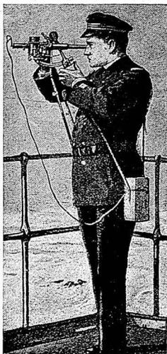
Fig. 4.<sup>a</sup> Observación nocturna con el octante Ponthus y Therrode
