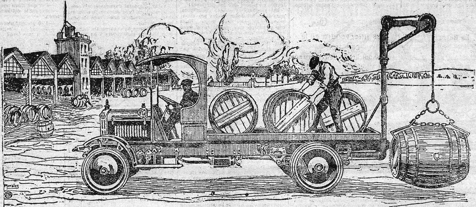
Tipos especiales basculantes y para carga y descarga automática de bocoyes
