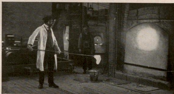
Fig. 3. Extracción de probetas para seguir la marcha de fusión
