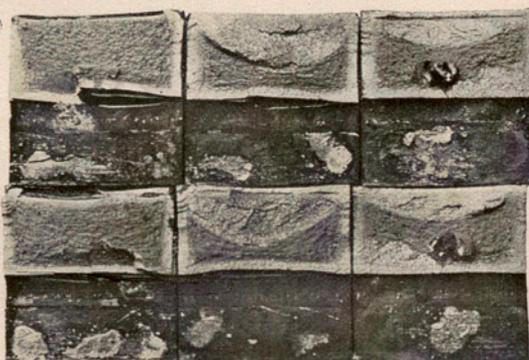
Fig. 24.<sup>a</sup> Estructuras correspondientes a la tabla 5 Tratamiento doble. Estructura fibrosa
