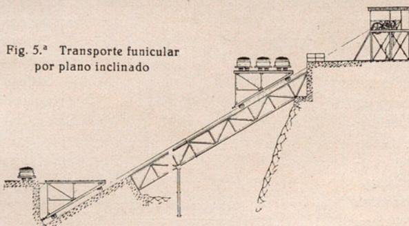
Fig. 5.ª Transporte funicular por plano inclinado
