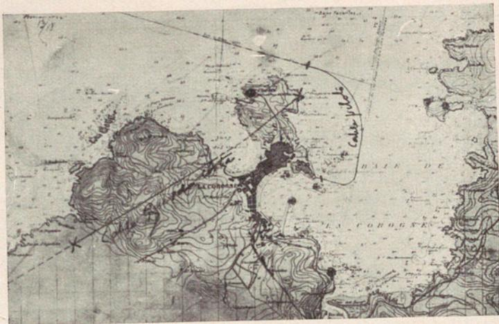
Fig. 1.<sup>a</sup> Plano del puerto de La Coruña con el trazado del cable Loth
