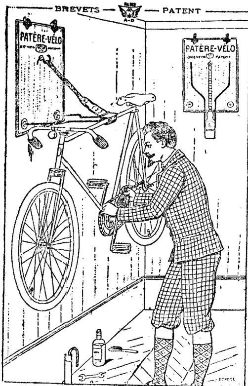
Aparato para prueba y recomposición de máquinas
