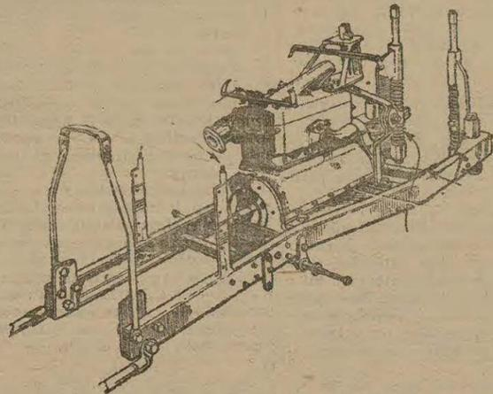
El chasis descarnado de la A. J. W. con el motor cuatro cilindros y con los pivotes de la dirección, con los muelles de suspensión.
